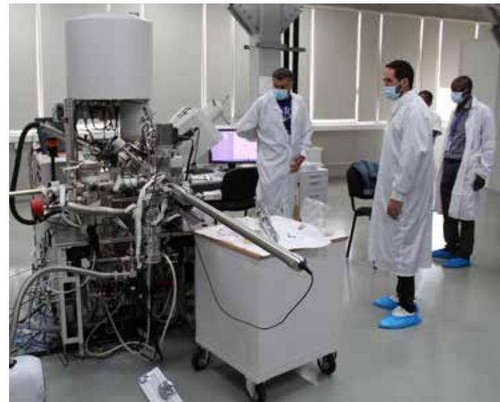
Installations de sédimentation par pulvérisation en mode magnétron, courant continu, radiofréquence ou mode pulsé ©CIFRA
